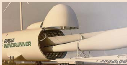
Il velivolo. Il WindRunner per trasportare pale eoliche e mezzi della Difesa
