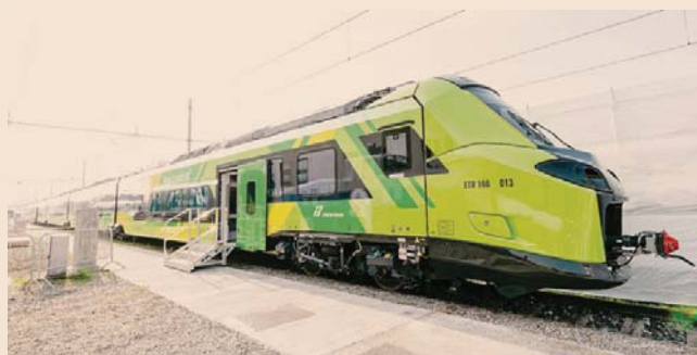
Regionale. Il nuovo treno, prodotto da Alstom a Savigliano, prevede una velocità massima che passa da 160 a 200 km/h
